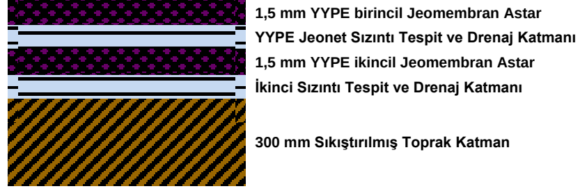
Şekil I.7. Yüklü Çözelti Havuzu Tabanı Astar Yapısı Basitleştirilmiş Gösterimi
