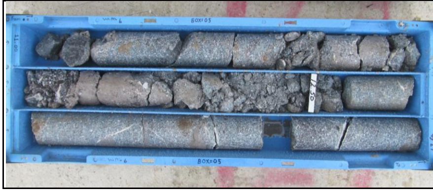
Fay zonuna denk gelen andezitte oluşmuş kırık/çatlak sistemleri ve alterasyon.
