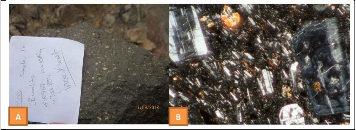
Şekil II.9. Bazaltik Volkanik Kayaçlar (A) Saha görünümü, (B) mikroskop görünümü.
