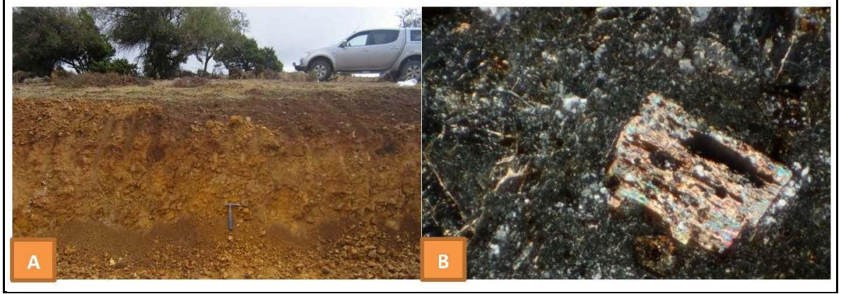
Şekil II.6. Andezitik Subvolkanikler (A) Orta derecede arjillik andezit saha görünümü, (B) Serisitleşme ve kil alterasyonu geçirmiş andezit mikroskop görünümü
